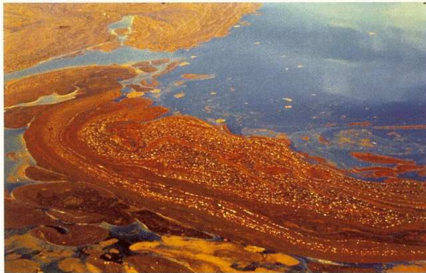
Figura 3.2: Formação de emulsão água-óleo. Fonte: FINGAS (2001).
