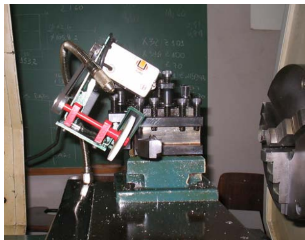
B - Conjunto de retificação montado com \alpha = 30^\circ
