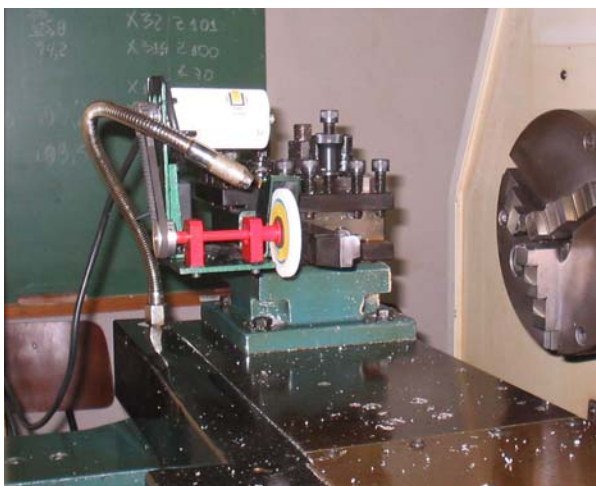
A - Conjunto de retificação montado com \alpha = 0^\circ
