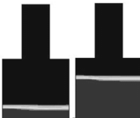
Figura 5 - Descompressão e compressão na câmara CAO.
