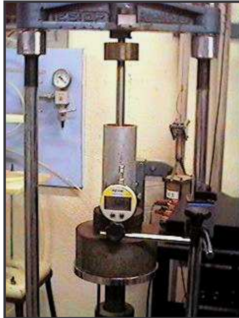
Figura 5.5 - Detalhe do ensaio de penetração mini-CBR.
