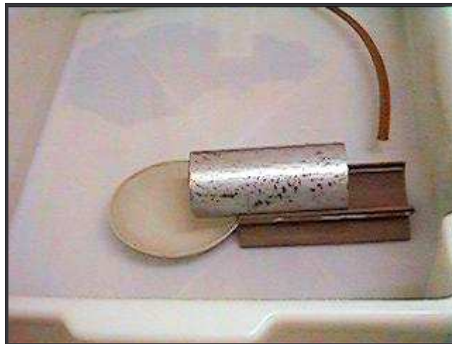
Figura 5.4 - Ensaio de perda por imersão da Metodologia MCT.
