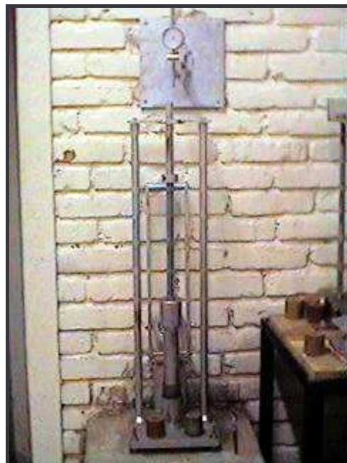
Figura 5.3 - Equipamento de compactação miniatura utilizado nos ensaios de compactação da Metodologia MCT.
