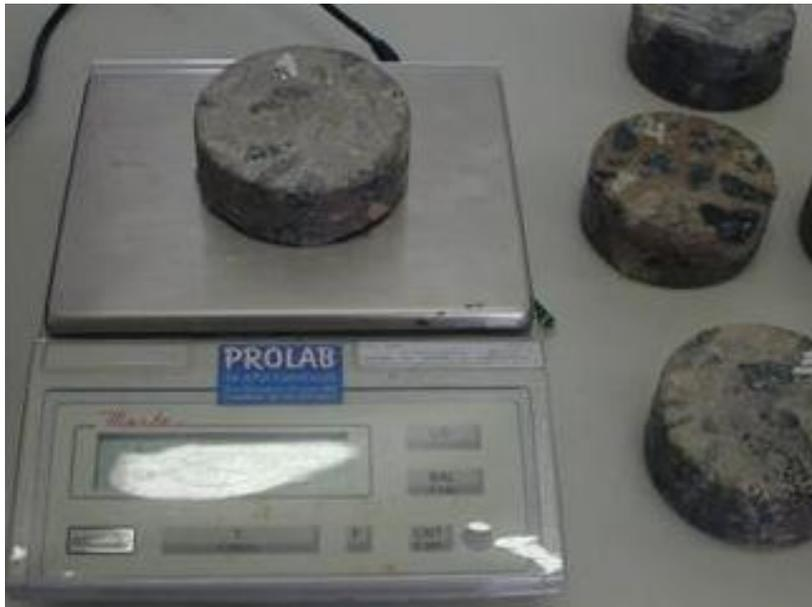
**Figura 2.1:** Medições das massas dos testemunhos de concreto. SOUZA (2005)
