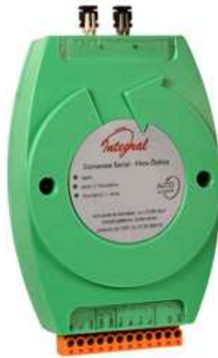
Figura 3.5 – Conversor RS-232 – Fibra Ótica da Integral
