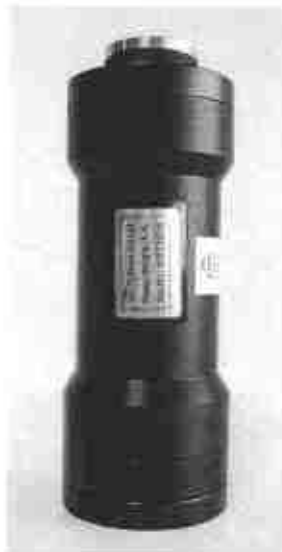
Figura 4.9 - Altímetro PA200 fabricado pela Tritech International Limited.
