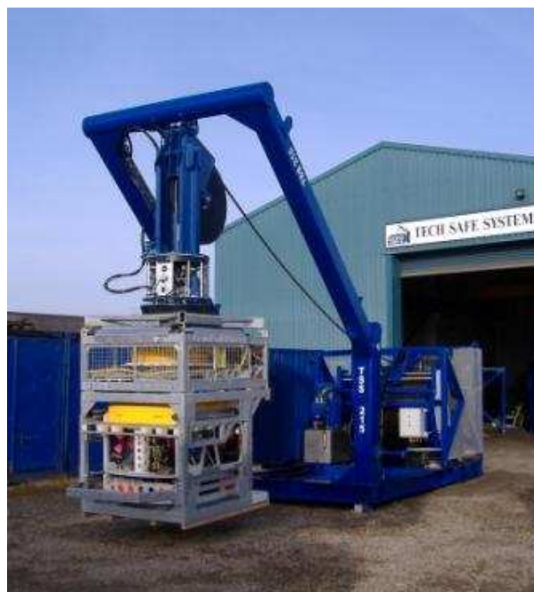
Figura 2.14 – Guincho hidráulico fabricado pela Tech Safe Systems
