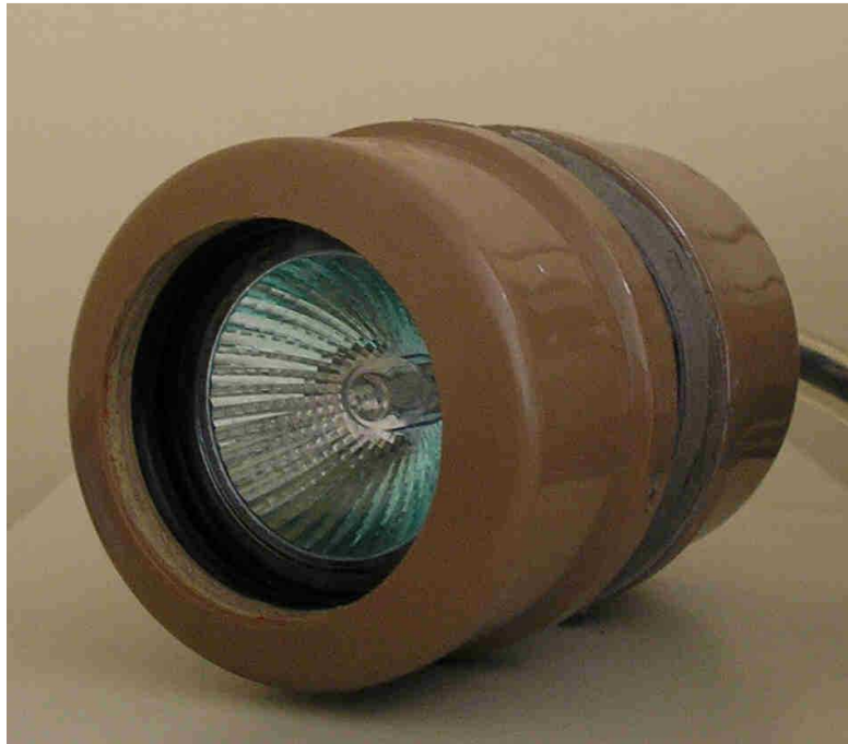
Figura 4.10 - Subsistema de iluminação do ROVFURG II
