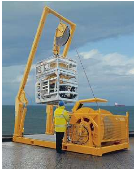
Figura 2.15 – Guincho hidráulico fornecido por Saab Seaeve Limited.
