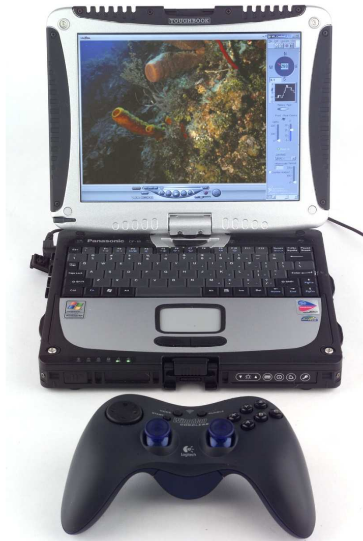
Figura 2.8 – Painel de controle baseado em um notebook utilizado pela VideoRay
