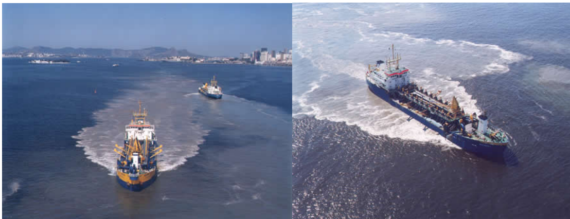
Figura 7.1: Ressuspensão de sedimentos verificada durante a operação de dragagem. Fonte: site da Dragaport, 2006.
