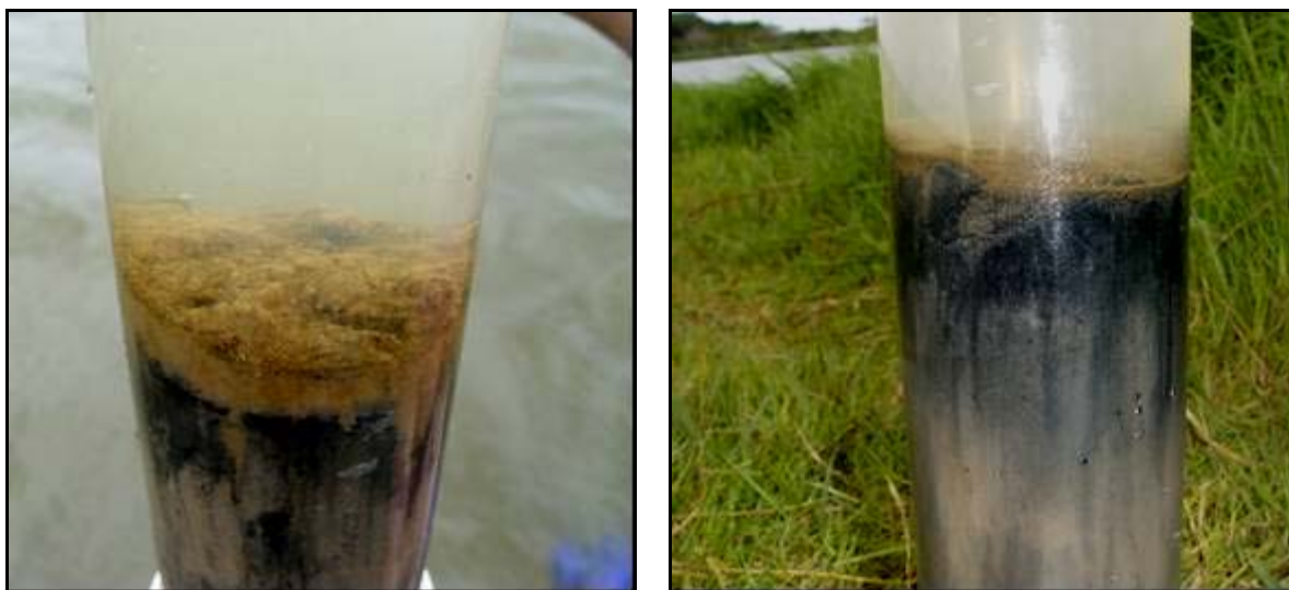
Figura 10: Testemunhos sedimentares obtidos na campanha 1. O da esquerda é proveniente do viveiro e o da direita da bacia de sedimentação. Observa-se uma camada superficial oxidada mais espessa no do viveiro comparada a da bacia de sedimentação.
