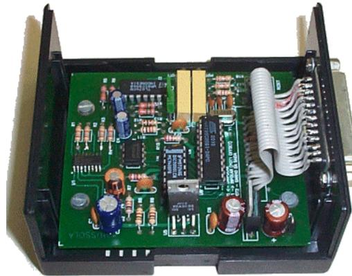
**Figura 8: Bússola eletrônica**
