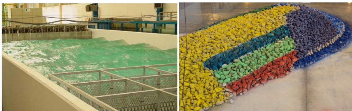
Figura 2 – Vista da bacia sem estrutura (esquerda) e do molhe construído (direita).
