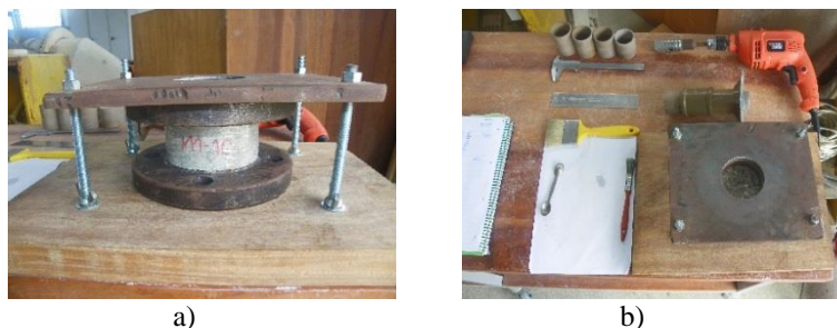
Figura 1. a) equipamento fabricado para a extração nas amostras de concreto; b) todas as ferramentas e equipamentos utilizados para a extração.
