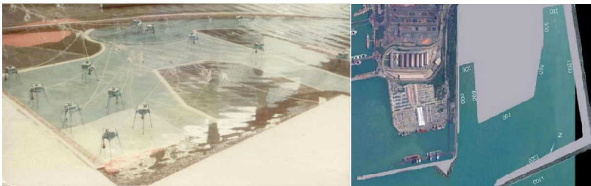
Figura 1. Modelo físico tridimensional de Praia Mole e arranjo geral do estudo.
