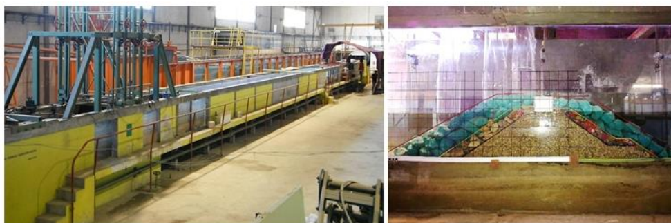
Figura 1. Modelação física: canal (esquerda) e modelo 2D à escala 1:30 (direita).
