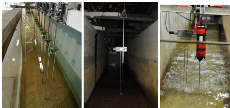
Figura 3. Conjunto de 8 sondas de nível (esquerda), sonda de nível junto ao bater (centro) e sondas ADV e de nível (direita).
