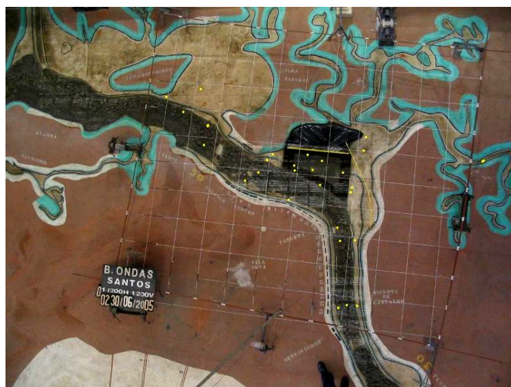
Figura 11. Derivadores simulando a dispersão dos sedimentos finos em suspensão no Porto de Santos.
