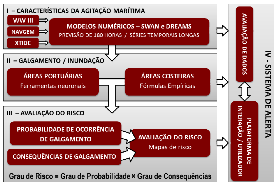
Figura 1. Esquema do sistema HIDRALERTA para as zonas costeiras e portuárias.
