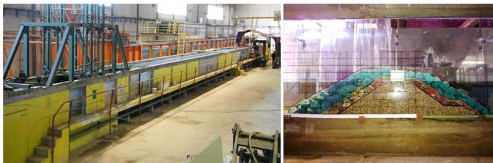
Figura 1. Modelação física: canal e modelo (2D) à escala 1:30.
