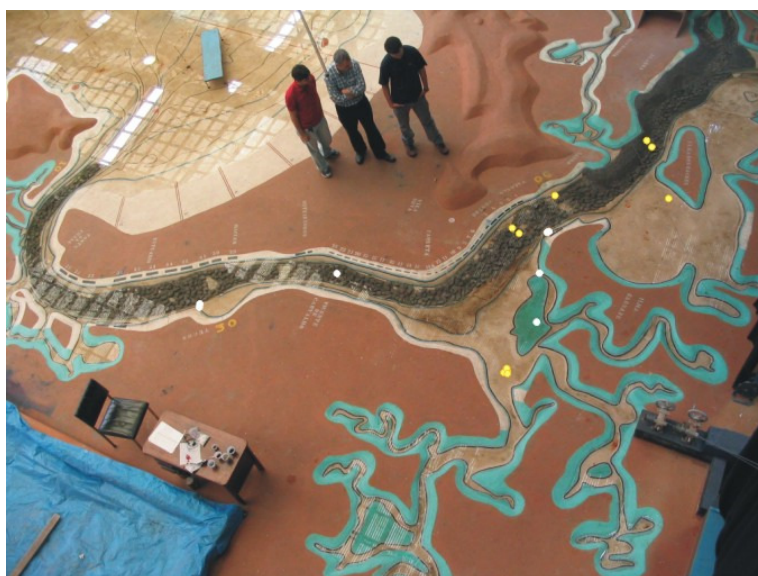
Figura 12. Derivadores simulando a dispersão de efluentes leves nos terminais de inflamáveis do Porto de Santos.
