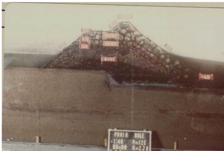
Figura 2. Modelo físico bidimensional de Praia Mole.
