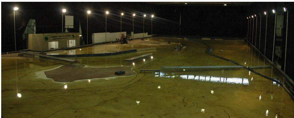
Figura 5. Vista geral do modelo físico tridimensional geral do Área Portuária do Maranhão, que ocupa no Laboratório de Hidráulica uma área superior a 1.000 m 2 .
