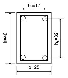
Fig. 6 - Seção transversal (medidas em cm)
