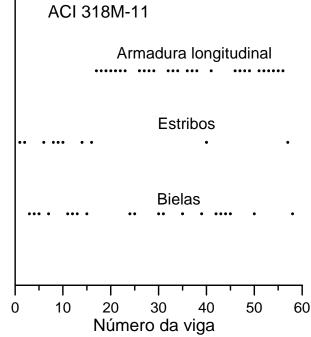
Fig. 16 – Modos de ruptura indicados pelo método do ACI 318M-11
