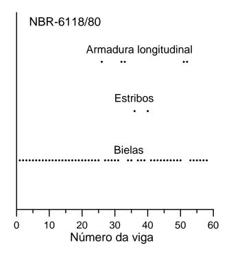
Fig. 12 – Modos de ruptura indicados pelo método da NBR-6118/80
