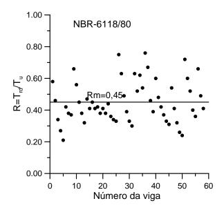
Fig. 7 – Verificação do método da NBR-6118/80
