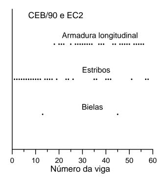
Fig. 15 – Modos de ruptura indicados pelo método do CEB/90 e EC2
