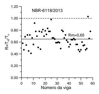
Fig. 8 – Verificação do método da NBR-6118/2013
