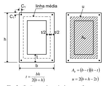
Fig. 3 – Seção vazada equivalente conforme a NBR-6118/2013 (Caso 1)
