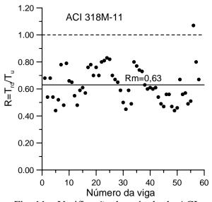
Fig. 11 – Verificação do método do ACI
