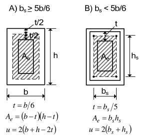
Fig. 2 – Seções vazadas equivalentes conforme a NBR-6118/80
