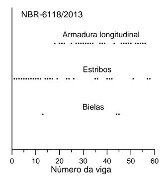
Fig. 13 – Modos de ruptura indicados pelo método da NBR-6118/2013
