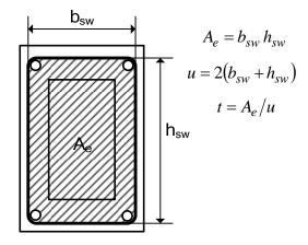
Fig. 5 – Seção vazada equivalente conforme o ACI
