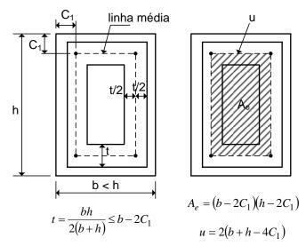
Fig. 4 – Seção vazada equivalente conforme a NBR-6118/2013 (Caso 2)
