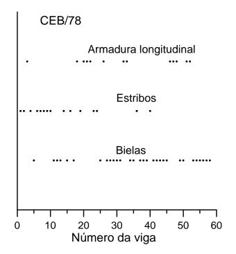
Fig. 14 – Modos de ruptura indicados pelo método do CEB/78
