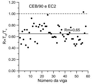
Fig. 10 – Verificação do método do CEB/90 e EC2
