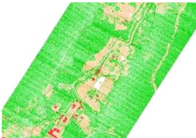
Figura 12 – Nuvem de pontos Laserscanner após filtragem, classificação e edição manual
