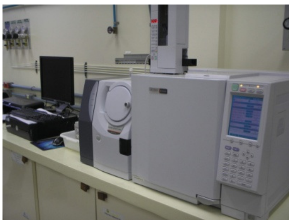
Figura 4. Equipamento de GC-MS utilizado para separação e determinação das espécies de mercúrio.
