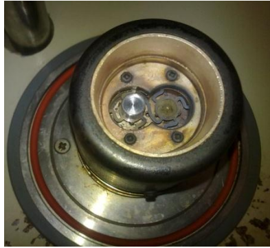
Figura 12. Interior da célula calorimétrica de DSC com fluxo de calor.
