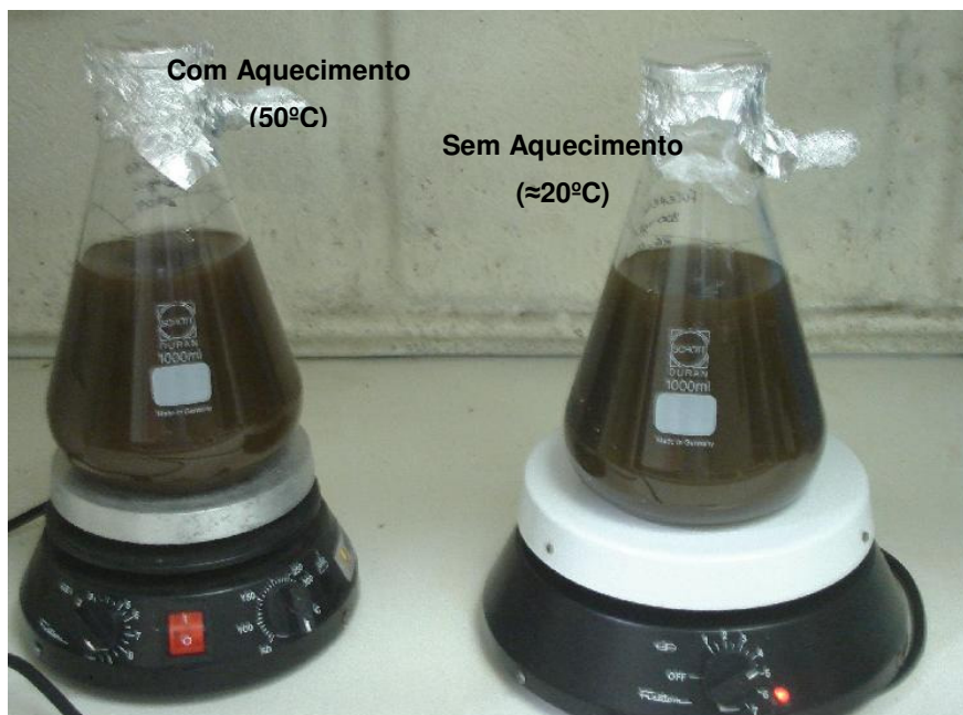
Figura 2: Preparo das suspensões de n\text{-C}_{60} com aquecimento ( 50^{\circ}\text{C} ) e sem aquecimento ( \approx 20^{\circ}\text{C} )
