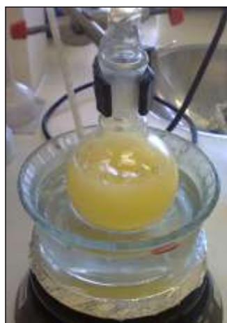
Figura 14. Saponificação do óleo de tungue.
