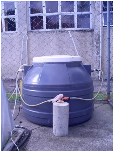
Figura A1 Reator anaeróbio de 310 L utilizado nos Ensaio 1 e 2.
