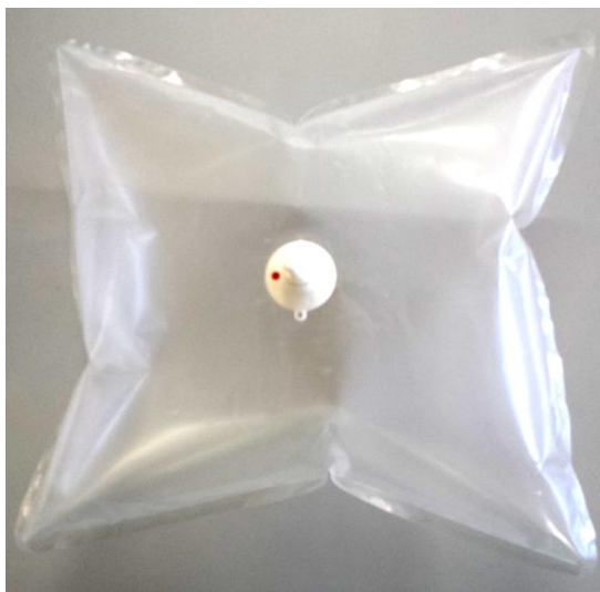
Figura A2 "Sample bag" utilizado para coleta do gás e envio à análise cromatográfica.
