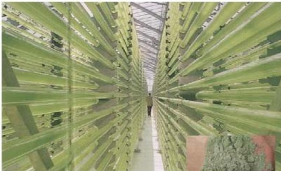
Figura 1 – Fotobiorreator utilizado no cultivo de microalgas 25
