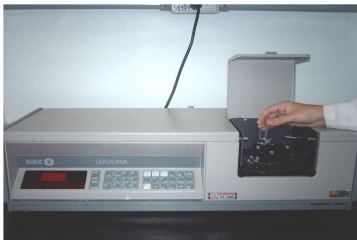
Figura 2.4 – Espectrofotômetro utilizado na determinação dos nutrientes nitrogenados (amônio, nitrito e nitrato)
