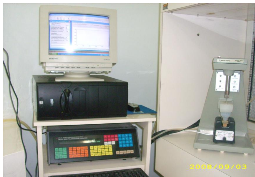
Figura 2.3 - Equipamento Polarográfico utilizado para a Especiação Química do Cromo
