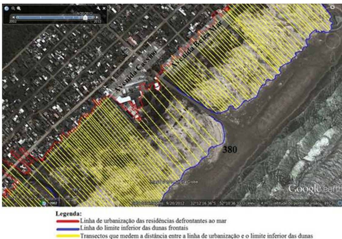
Figura 12 – Imagem aérea do começo a localidade Atlântico Sul no Balneário Cassino em 20/9/2012, destacando a distância entre a linha de urbanização e o limite inferior das dunas (linha de preamar marinha) (Fonte: Google Earth).
