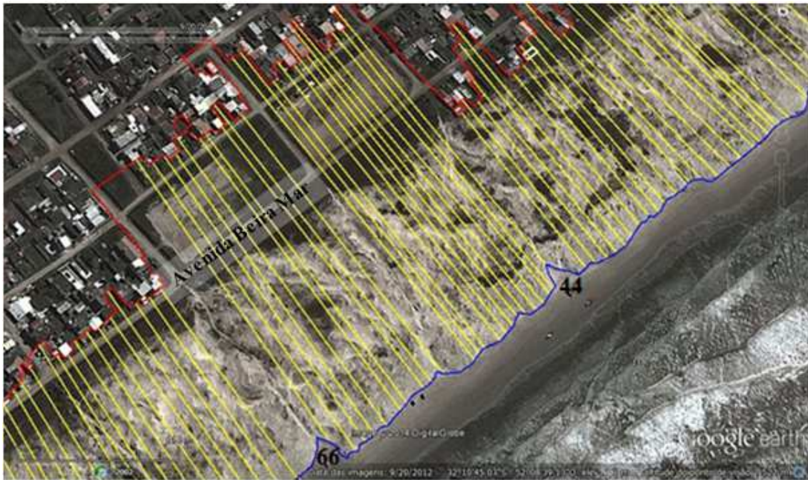
Legenda: — Linha de urbanização das residências defrontantes ao mar — Linha do limite inferior das dunas frontais — Transectos que medem a distância entre a linha de urbanização e o limite inferior das dunas
