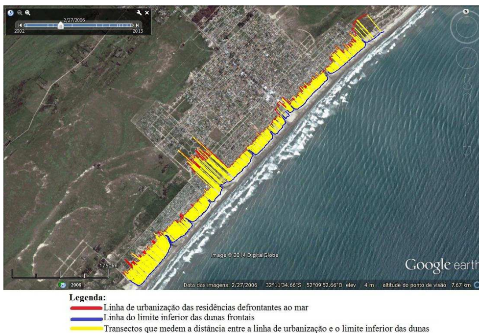
Figura 5 – Imagem aérea do Balneário Cassino em 27/2/2006, destacando a distância entre a linha de urbanização e o limite inferior das dunas (linha de preamar marinha) (Fonte: Google Earth).
