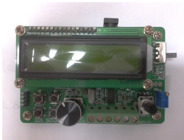
Figura 21: Gerador de funções, equipado com processador MAX II EPM240
