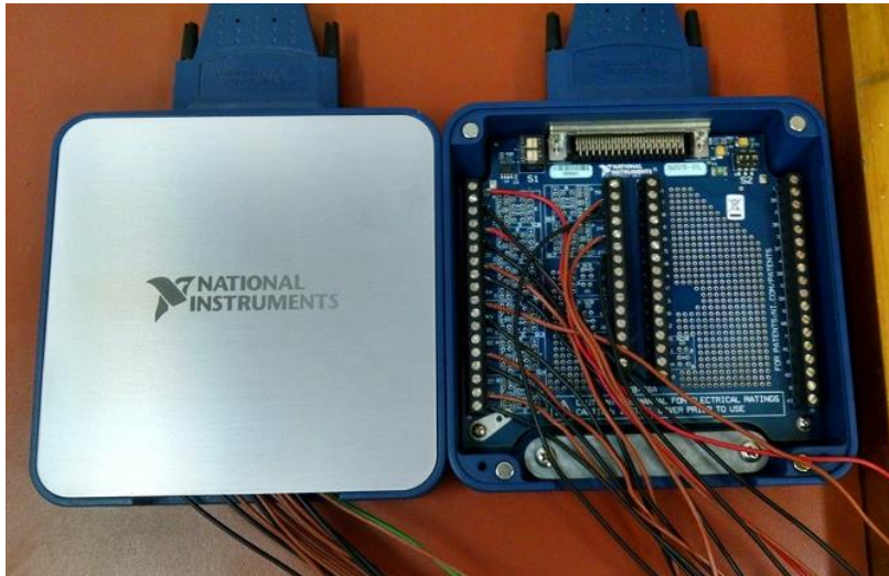
Figura 23: SCB-68A e SCB-68B são placas de aquisição de dados de uso geral com entradas I/O analógicas e digitais, além de funções exclusivas.
