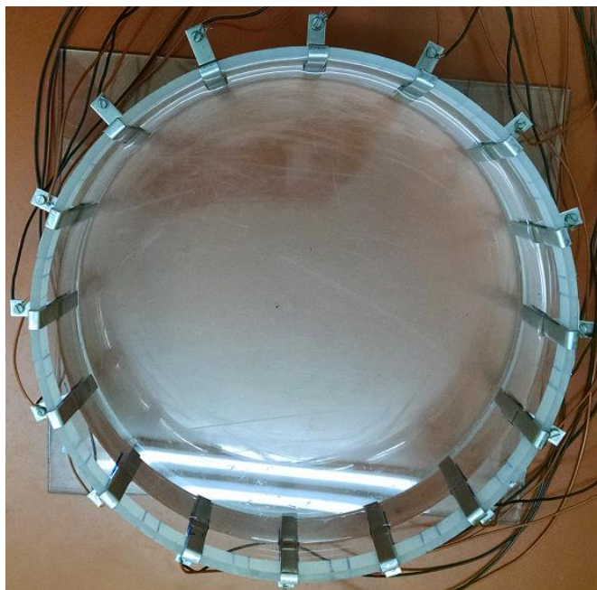
Figura 19: Corpo de provas composto por tubo de acrílico com 30 cm de diâmetro, chapa de PETG fechando o fundo do tubo e 16 eletrodos de aço inox AISI 304 distribuídos equidistante em média 5,90 cm um do outro.
