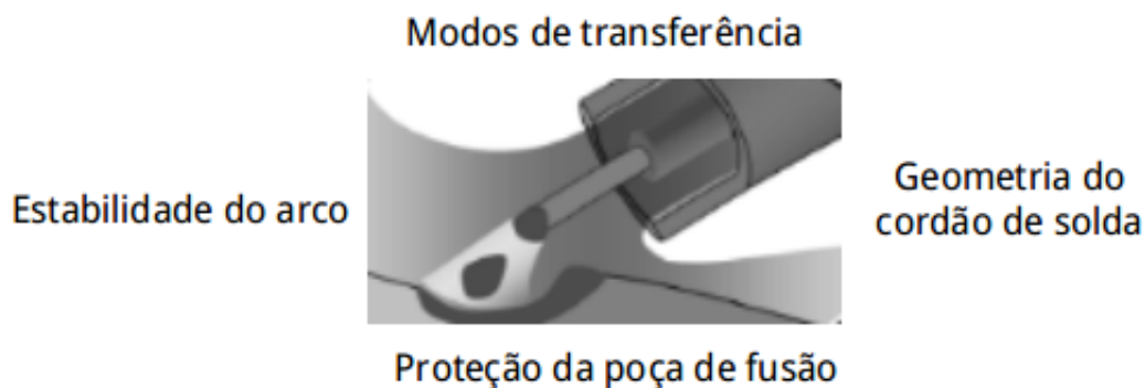
Figura 3: Principais características dos gases de proteção adaptado de [43]
