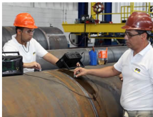
Figura 7: Técnica de Ultra-Som. Disponível em ( INSPECAOULTRASOMTESTE, )
