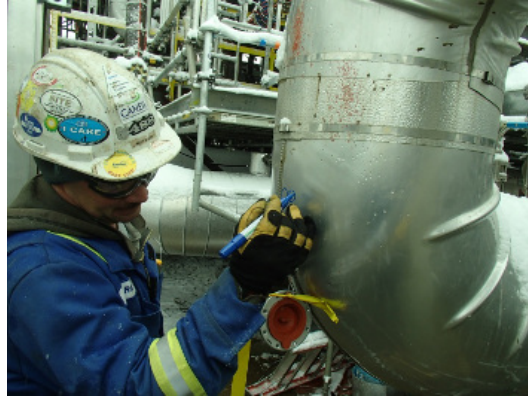
Figura 6: Técnica de Inspeção Visual. Disponível em ( VISUAL... , )
