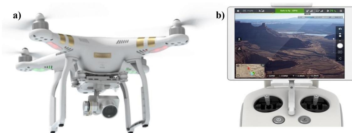
Figura 11. (a) Drone Phantom 3 profissional. (b) Controle do drone Phantom 3 Professional e tablet acoplado, com destaque para as informações contidas na telemetria do equipamento (fonte: [www.dji.com](http://www.dji.com)).
