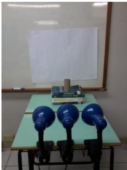
Figura Erro! Nenhuma seqüência foi especificada. - Três luminárias, anteparo e cartolina posicionados para obtenção das sombras coloridas.
