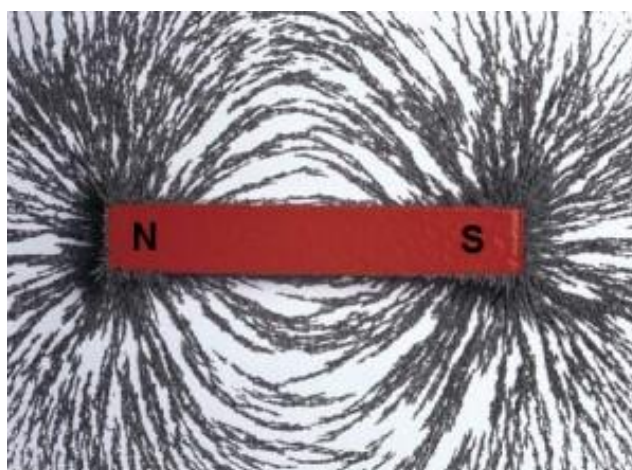
Figura Erro! Nenhuma seqüência foi especificada. - Configuração da limalha de ferro, próximos de um ímã em barra.
