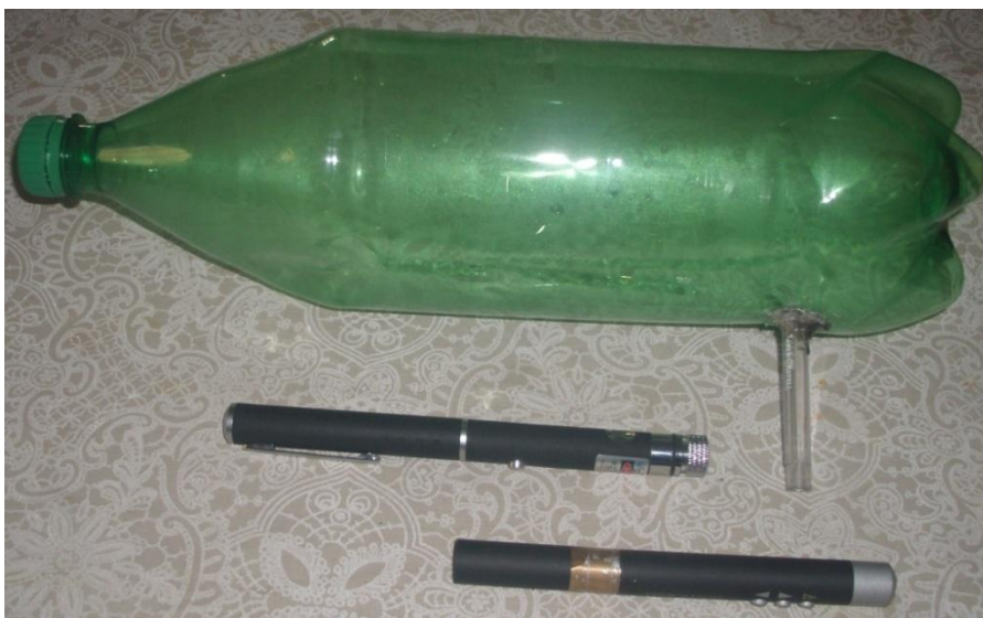
Figura Erro! Nenhuma sequência foi especificada. - Garrafa pet com cano fino acoplado e dois lasers.
