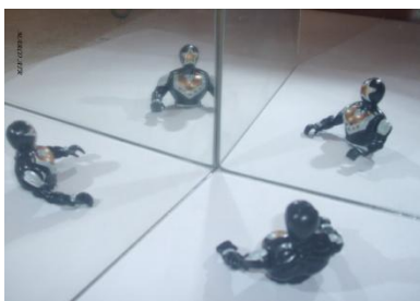
Figura Erro! Nenhuma seqüência foi especificada. - Espelhos posicionados formando um ângulo de 90^\circ .
