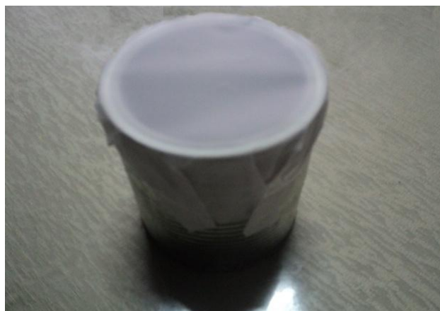
Figura Erro! Nenhuma seqüência foi especificada. - Papel vegetal fixado com fita adesiva na “boca” da lata.
