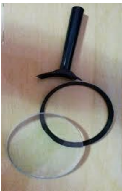
Figura Erro! Nenhuma seqüência foi especificada. - Lupa desmontada, pronta para ser fixada na câmara escura.
