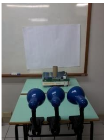
Figura Erro! Nenhuma seqüência foi especificada. - Objetos organizados para a obtenção das sombras coloridas.
