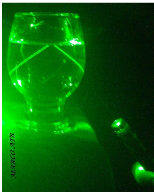
Figura Erro! Nenhuma seqüência foi especificada. - Reflexão total da luz verde na superfície do líquido.
