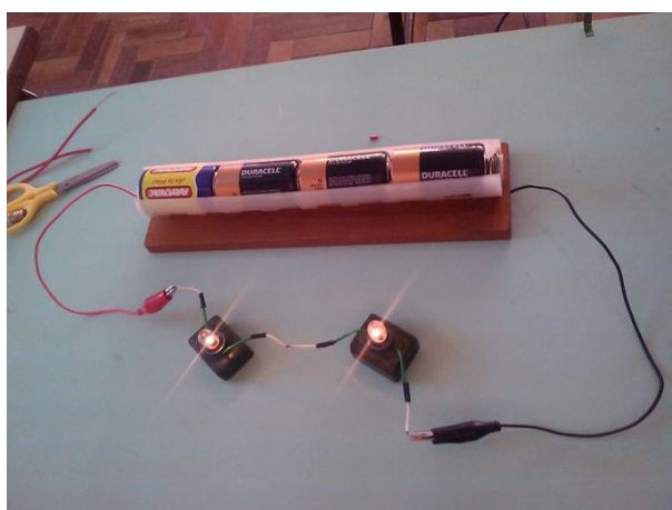
Figura Erro! Nenhuma seqüência foi especificada. - Lâmpadas associadas em série apresentam menor luminosidade.
