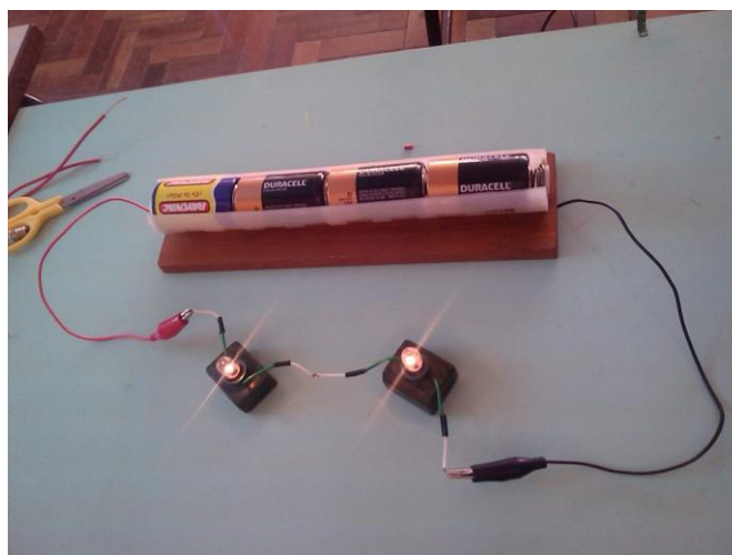
Figura Erro! Nenhuma seqüência foi especificada. - Lâmpadas associadas em série para produzir baixa luminosidade.
