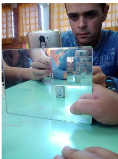
Figura Erro! Nenhuma seqüência foi especificada. - Espelhos dispostos em paralelo para obtenção de infinitas imagens da borracha.
