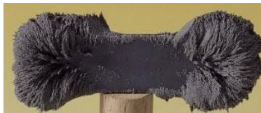
Figura Erro! Nenhuma seqüência foi especificada. - Limalha de ferro acumulada nas extremidades do ímã, nas quais se localizam os polos magnéticos.
