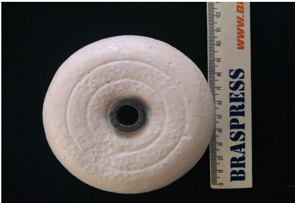
Figura 32: Derivador utilizado para medição da velocidade da corrente e posterior estimativa da vazão dos sangradouros. Foto: A autora.
