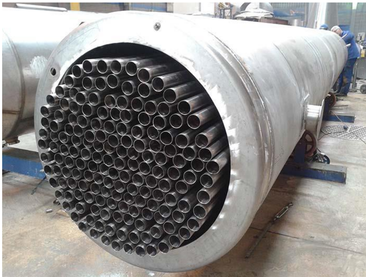
Figura 1.1 – Trocador de calor do tipo casco e tubos encontrado em aplicações industriais (Fonte: Cengel e Ghajar, 2015).
