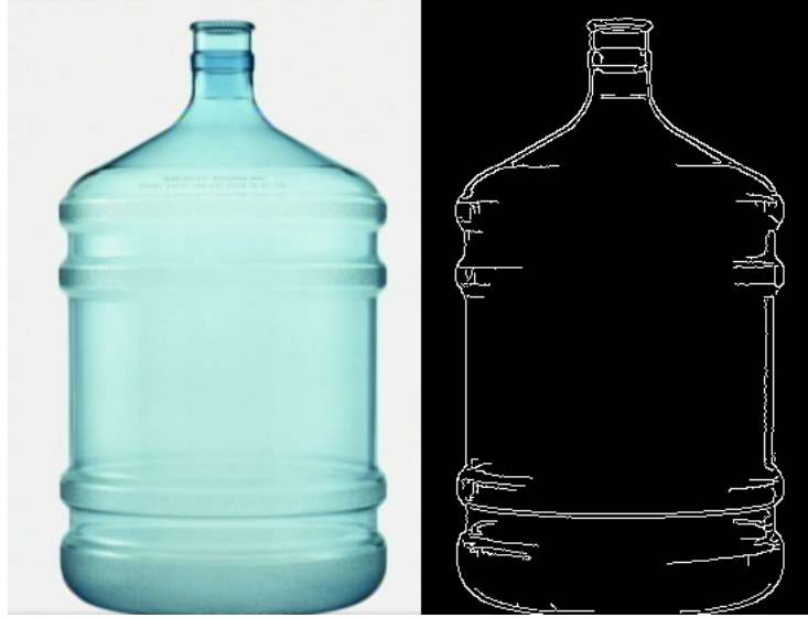
Figura 4.4: (a) Imagem original (b) Imagem com bordas extraídas após aplicação do algoritmo de Canny.
