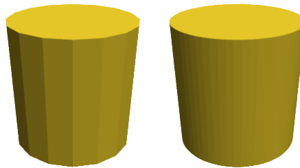
Figura 5.2: Cilindros idênticos desenhados com densidades de malhas distintas, no software OpenSCAD (KINTEL; WOLF, 2017)
