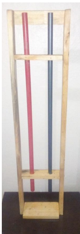
Figura A2.4: Conjunto experimental do freio magnético montado.
