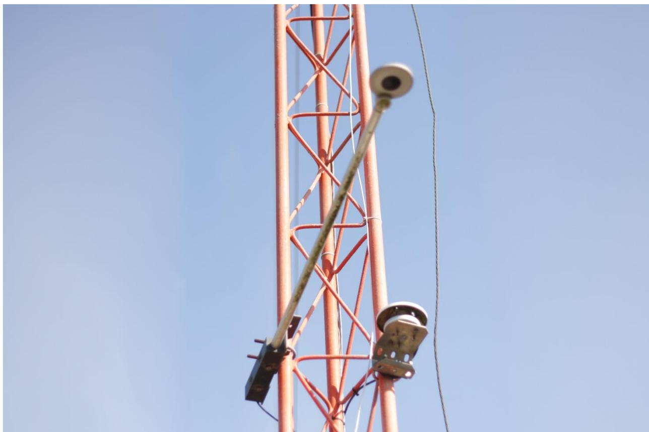
Figura 4.4 – Equipamentos instalados na torre, radiômetro a esquerda e piranômetro a direita (Fonte: Ribas, 2017).
