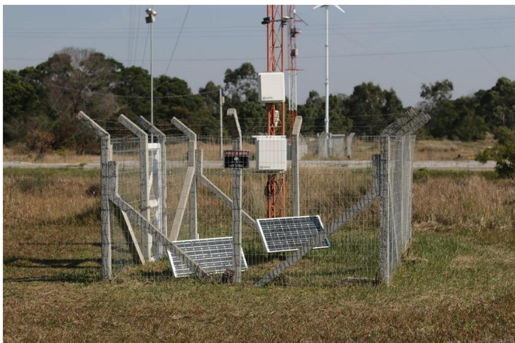
Figura 4.3 – Base da torre, mostrando os painéis solares e compartimentos de armazenamento do datalogger e da bateria (Fonte: Ribas, 2017).
