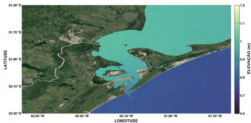
Figura 3.1: Campo médio da elevação da superfície livre para o período de 01 de janeiro a 31 de dezembro.
