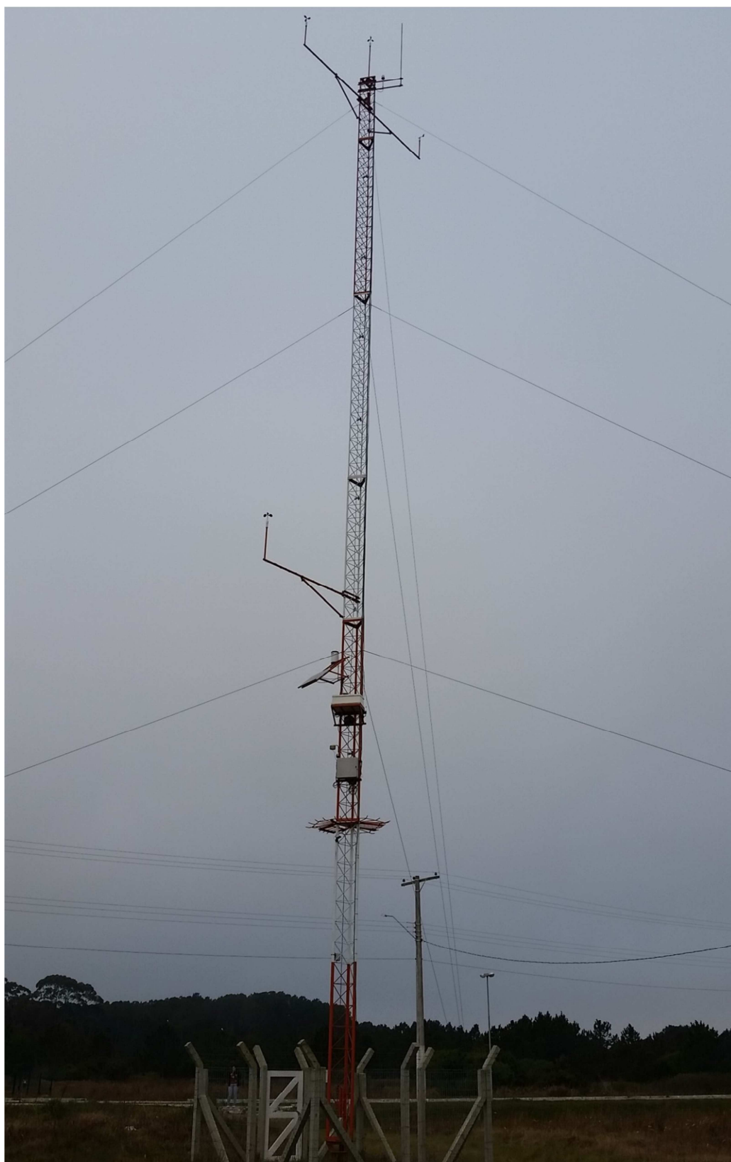
Figura 5-2 – Torre anemométrica com os equipamentos de medição. Foto: R. Zanotta (07/2017).
