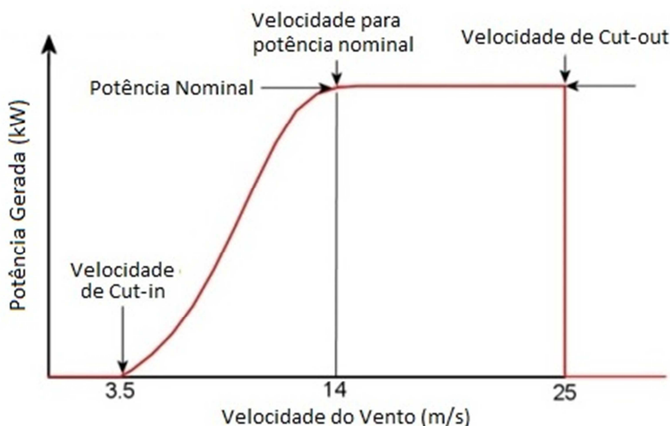
Figura 4-2 - Forma típica da curva de potência de um aerogerador, com indicativo das velocidades de início de geração, de potência nominal e de corte, como em Wind (2016).
