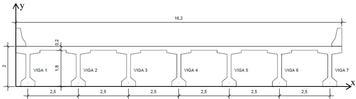
Figura 3.18 - Corte transversal e longitudinal da ponte de exemplo, dimensões em m (TRENTINI; MARTINS, 2015)
