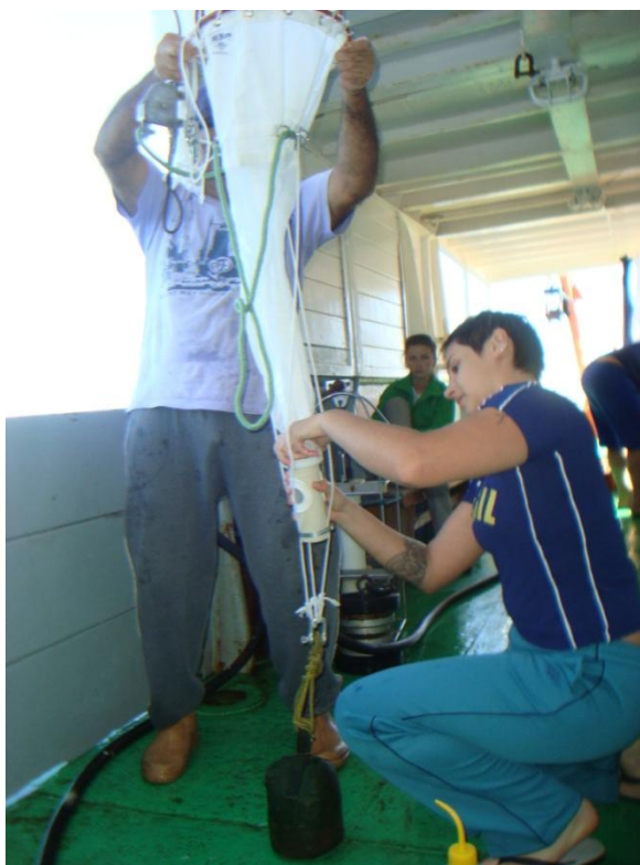
Fig. 5: Coleta de parâmetros biológicos utilizando a rede de fitoplâncton com de malha de 50 \mu\text{M} .
