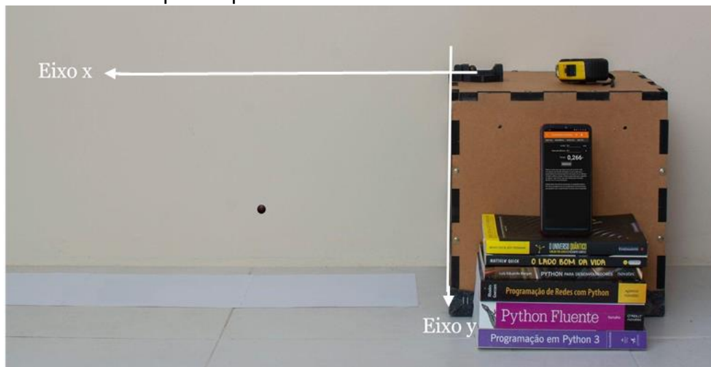
Figura 1.: Representação experimental do lançamento horizontal de uma esfera de aço com um canhão de Gauss e o uso do Smartphone para a determinação do tempo de queda através do cronômetro acústico.
