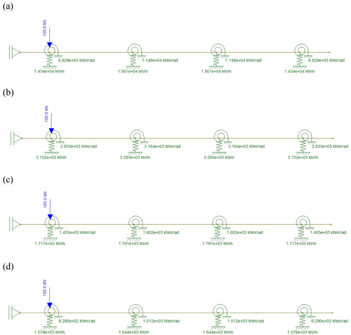
Figura 3.35 - Viga que representa a ponte de 4 longarinas com a carga aplicada no tabuleiro, para o vão de: (a) 10 m; (b) 20 m; (c) 30 m; e (d) 40 m.
