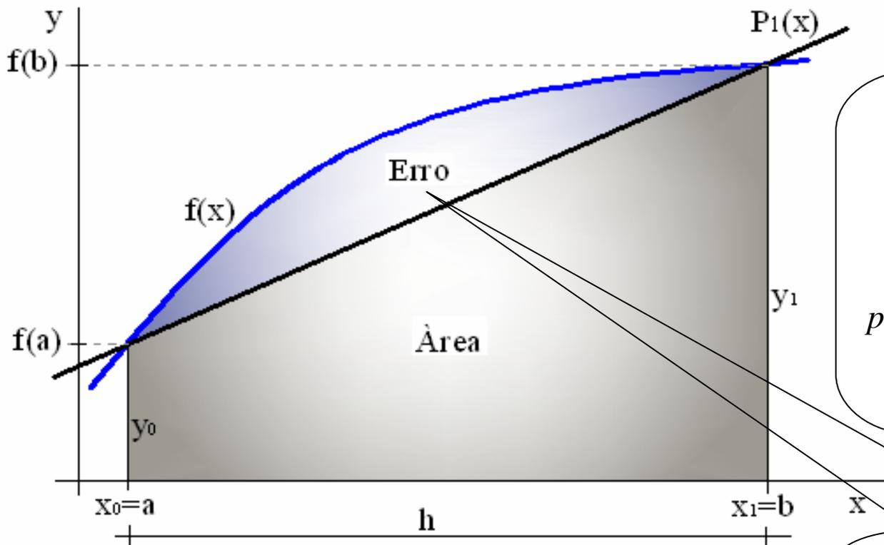
*Note que a Regra dos Trapézios consiste em substituir a função  $f(x)$  por um polinômio de primeira ordem  $P_1(x)$ . Logo, como pode ser observado na figura, tem-se a **Área (I)** formada por um trapézio.*
