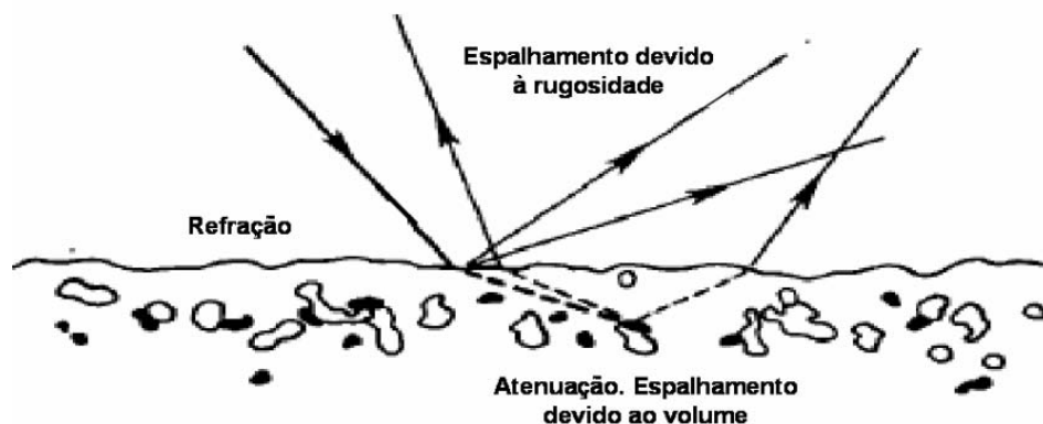
Figura 2.2. Mecanismos de espalhamento acústico no fundo, incluindo a refração na interface água-sedimento, além da atenuação e espalhamento no volume de sedimento. Modificado de Jackson et al (1986)
