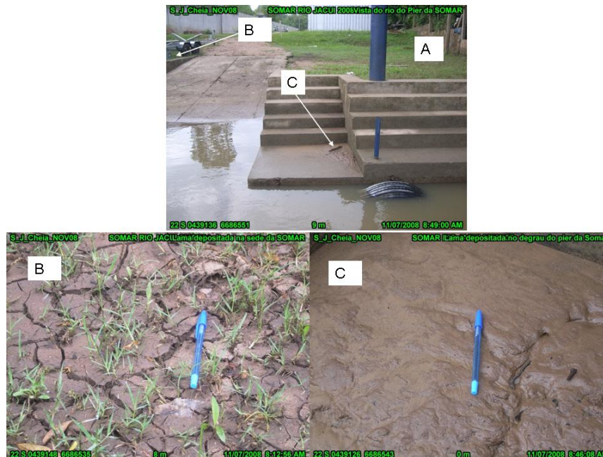
Figura 4.3. (a) Cais da SOMAR e a ocorrência dos depósitos de sedimentos; (b) gretas de contração; (c) depósito recente de lama no degrau do pier.
