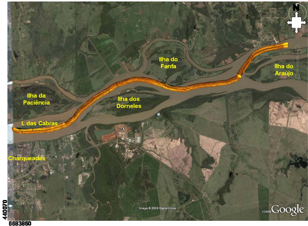
Figura 4.20. Mosaico das imagens obtidas com o sonar de varredura lateral num trecho do rio Jacui, dentro da área estudada.
