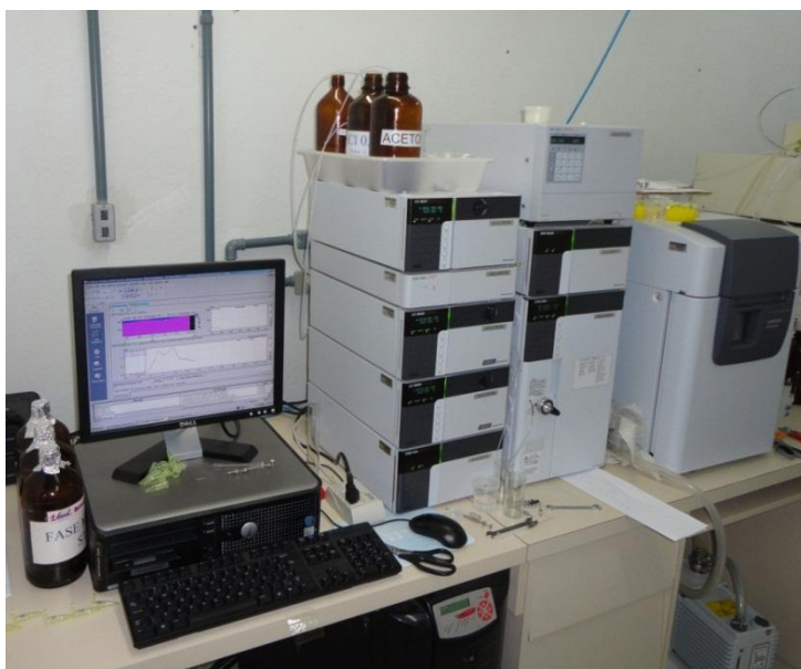
Figura 6: Shimadzu LC-20 a , com controladora CBM-20A, detectores de fluorescência (RF-10Ax1), UV-VIS, (SPD-M20A PDA Photo Diode Array), bombas LC-20AD e forno CTO-20A.
