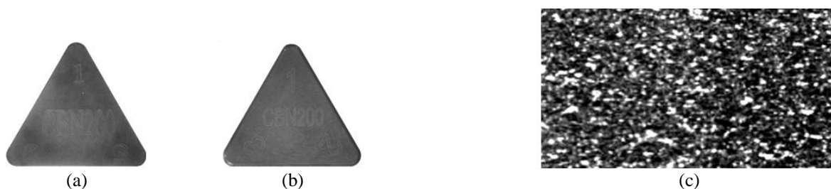
Figura 2. (a) Insertos com geometria S, (b) geometria E e (c) imagem obtida em MEV do inserto CBN200 (Seco Tools, 2005).
