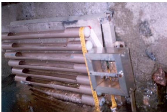
Figura 5 – Altura máxima de respingo indentificada pela água contida nas canaletas
