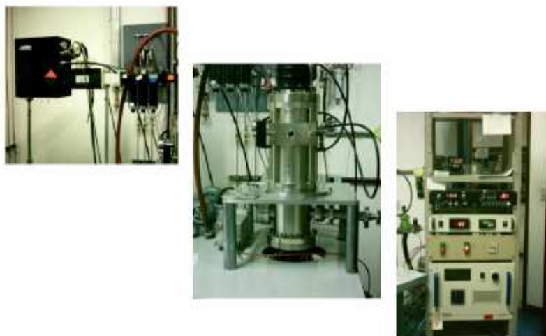
Figura 1: Foto do equipamento utilizado para produção dos filmes de diamante.
