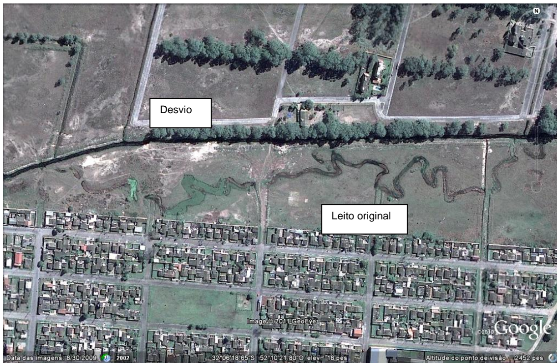
Figura 25. Os dois leitos do Arroio Vieira. Fonte: modificado de GOOGLEEARTH, 2010. (escala aprox. 1:5600)
