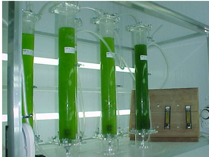
Figura A10 Cultivos realizados em FBRT de 2L em série.
