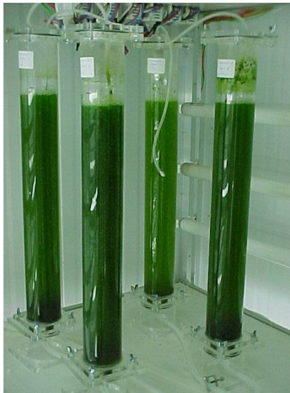
Figura A9 Cultivos realizados em FBRT de 2L.
