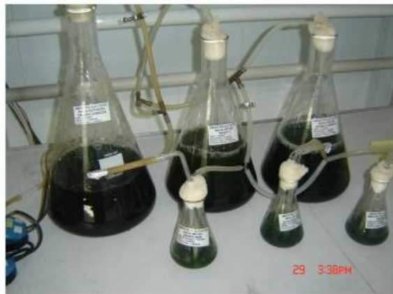
Figura A4 Amostras em fotobiorreatores fechados do tipo erlenmeyers de 6L e de 0,5L.
