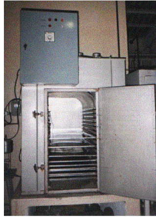
Figura 1 : Secador descontínuo de bandejas, com escoamento paralelo do ar de secagem, em escala piloto – Artigos 1 e 2
