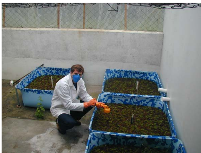
Figura 3. Procedimento de adicionamento de fração fina de solo contaminado com mercúrio no experimento de simulação do impacto do mercúrio em lago.
