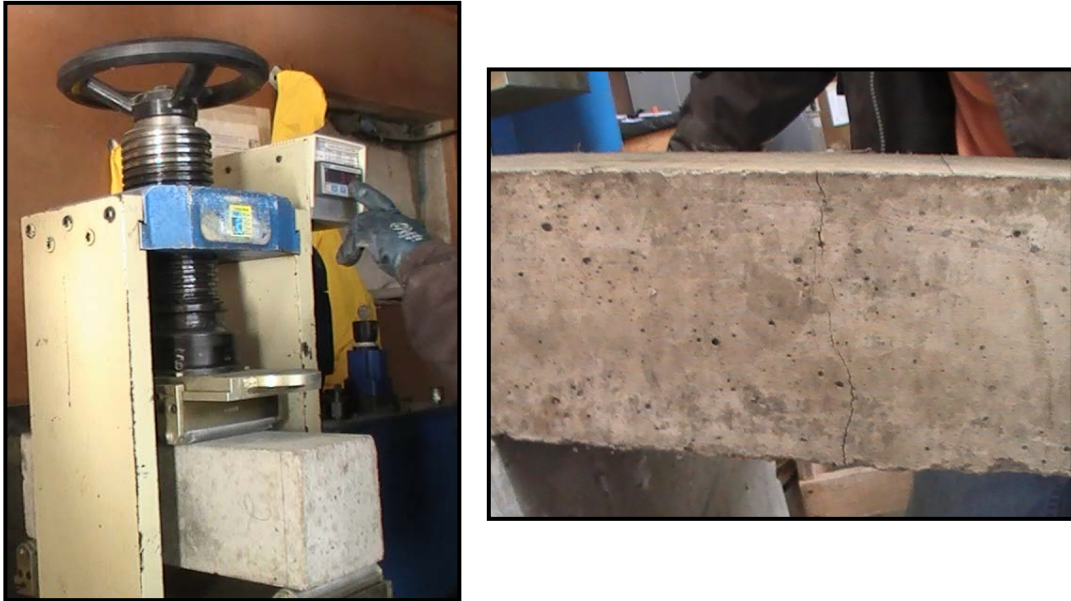
Figura 3.5 – Execução de ensaio de resistência á tração na flexão e detalhe do plano de ruptura do corpo de prova
