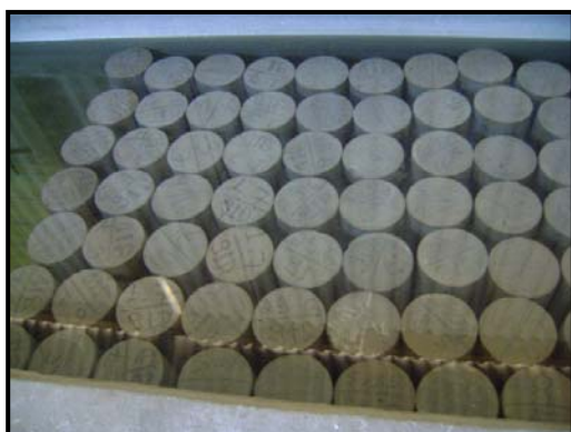
Figura 2.2 – Sistema de cura dos corpos de prova de concreto com controle automático de temperatura
