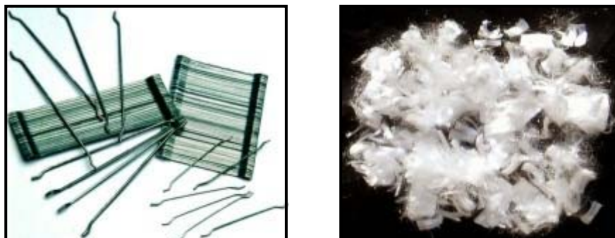
Figura 4.1 – Fibras de aço e polipropileno para concreto (Disponível em: < www.portaldoconcreto.com.br > Acesso em 10/out/2009)
