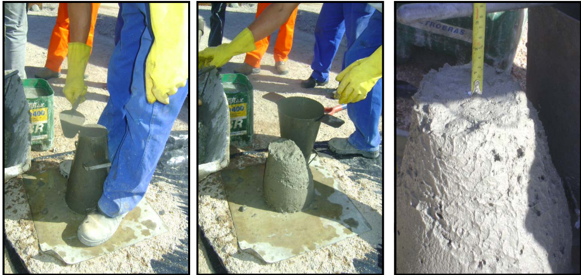
Figura 1.4 – Determinação da consistência do concreto pelo ensaio de abatimento do tronco do cone segundo a NBR NM 67 (ABNT, 1998)
