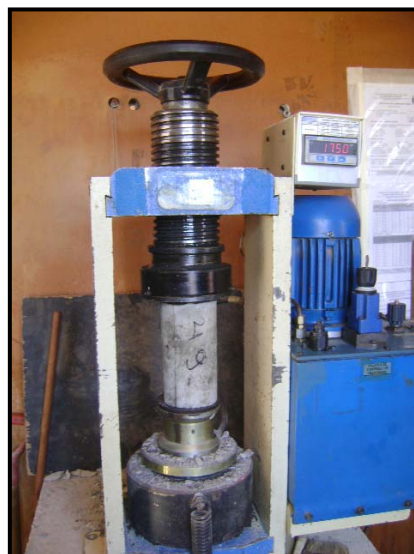
Figura 2.4 – Prensa para rompimento de corpos de prova de concreto
