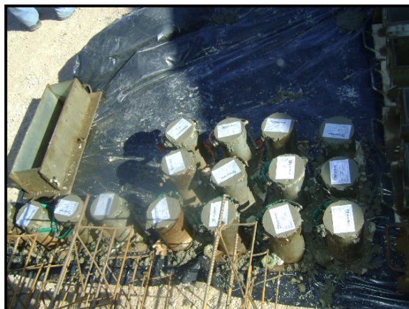
Figura 2.1 – Corpos de prova cilíndricos moldados segundo a NBR 5738 (ABNT, 2008)
