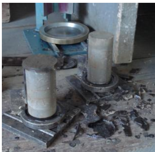
Fig. 3.4 – Capeamento dos corpos de prova.
