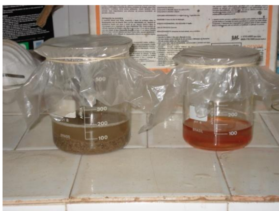
Fig. 3.7 – Mistura com areia e mistura da solução padrão.
