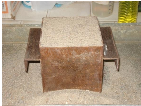
Fig. 3.6 – Massa específica aparente da areia.
