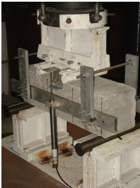
Fig. 3.25 – Sistema “yoke” montado no corpo de prova para ensaio de tração na flexão.
