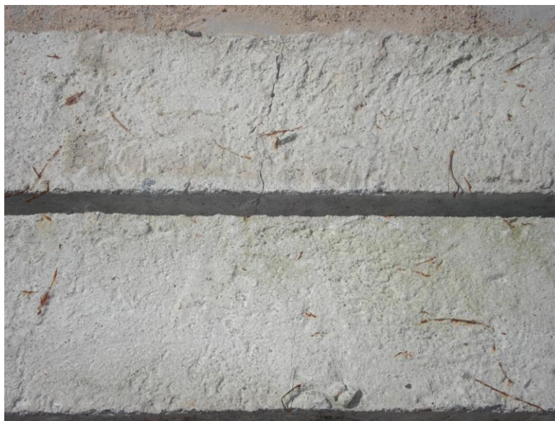
Fig. 4.4 – Situação dos blocos expostos por dois anos a condições climáticas variadas.
