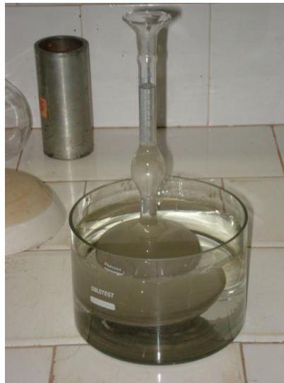
Fig. 3.2 – Ensaio de densidade do cimento.
