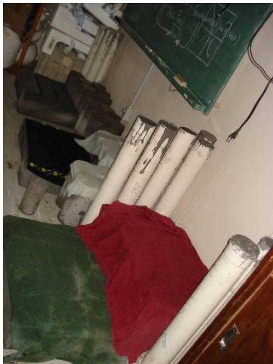
Fig. 3.26– Condições de cura úmida dos CP's.
