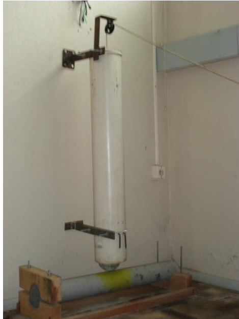
Fig. 3.28 – Corpo de prova de concreto no equipamento de ensaio de queda de esfera.
