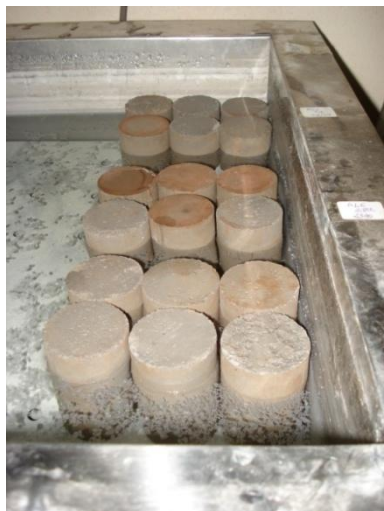
Fig. 3.3 – Corpos de prova imersos no tanque com água e cal.
