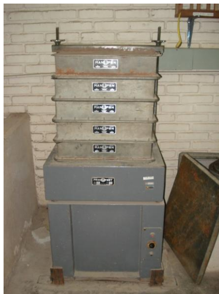
Fig. 3.8 – Peneiras no agitador para granulometria da brita.
