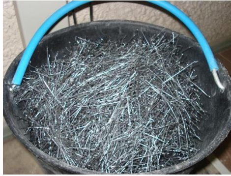
Fig. 3.21 – Fibras de aço utilizadas no ensaio de durabilidade.
