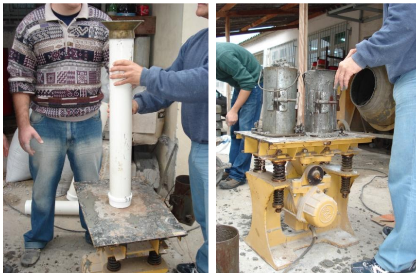
Fig. 3.16 – Adensamento por vibração mecânica externa.
