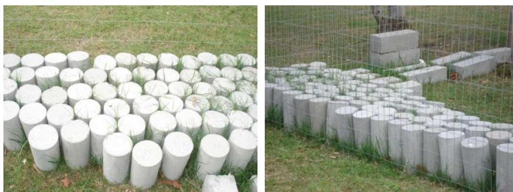
Fig. 3.23 – Estocagem dos corpos de prova expostos a intempéries.
