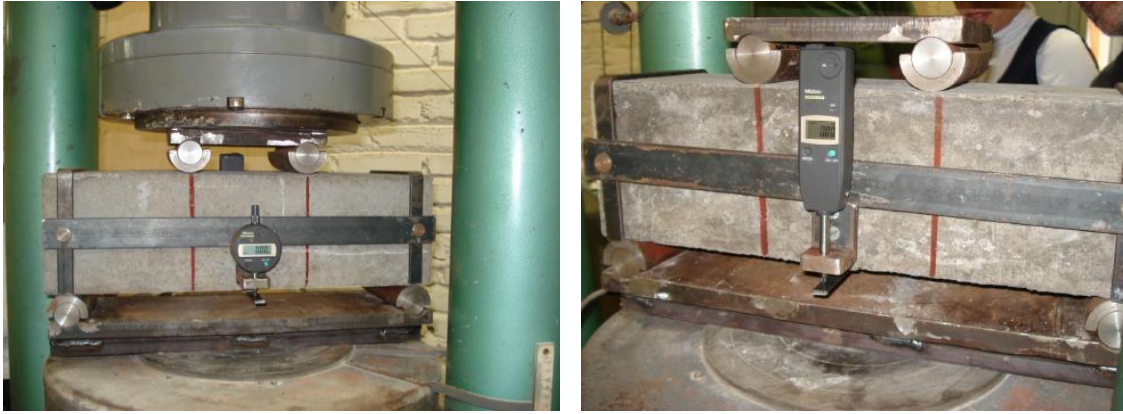
Figura 3.27 – Corpo de prova submetido ao ensaio de tração na flexão.
