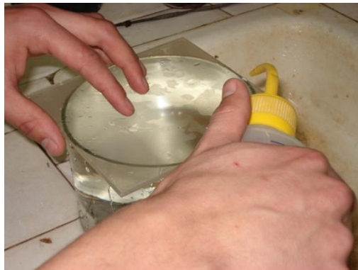
Fig. 3.9 – Frasco de água sendo rasado de modo a não obter bolhas.
