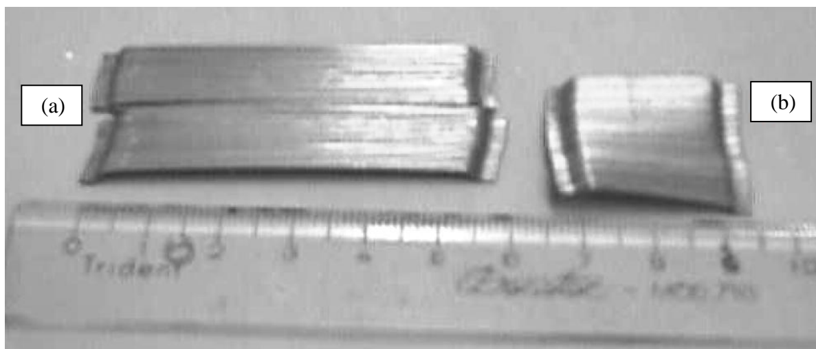
Fig. 2.45 – (a) Fibras de aço longas; (b) Fibras de aço curtas (FIGUEIREDO, 2000).
