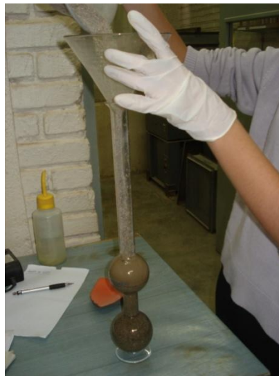
Fig. 3.5 – Ensaio de determinação da massa específica para agregado miúdo.
