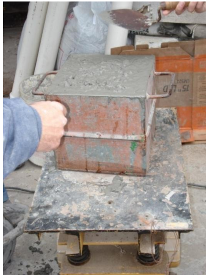
Fig. 3.18 – Peso específico do concreto fresco.
