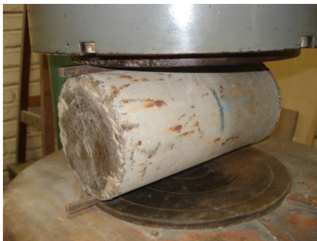
Fig. 4.2 – Ensaio de tração por compressão diametral para durabilidade.
