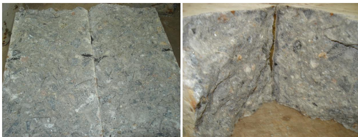
Fig. 4.3 – Interior dos blocos do ensaio de molhagem e secagem.
