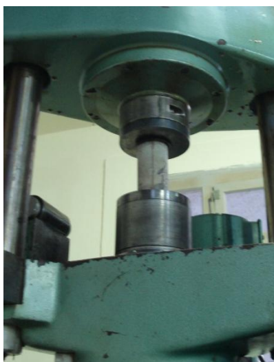
Fig. 3.20 – Ensaio de resistência à compressão (MIGLIORINI, 2007).
