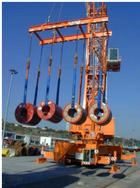
FIGURA 1.2 – Equipamento portuário com patolas
